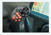
Les boutons souples sont rétroéclairés afin de faciliter la sélection des commandes dans l'obscurité.
