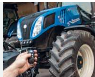
Système de verrouillage et d'anti-démarrage à distance monté d'usine
